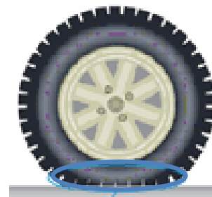
Déperdition d'énergie sous l'effet de déformations du pneumatique
